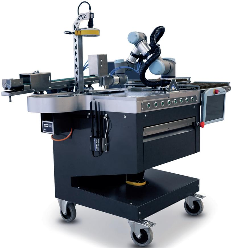
Das palettierHELD-System bietet alles, was beim Palettieren benötigt wird. Cobot, Kamera, Messtechnik – auf weniger als 0,5 m<sup>2</sup>
